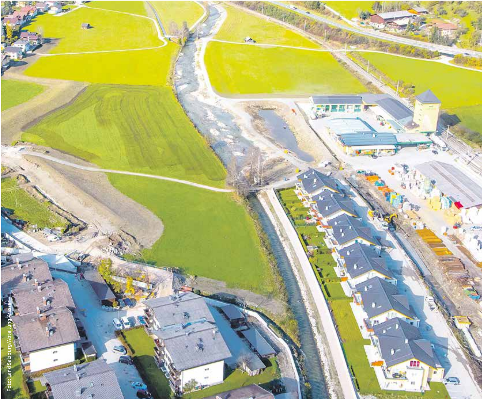
Hochwasserschutzmauern entlang der Enns (untere Bildhälfte rechts) und eine Aufweitung der Enns sind Bestandteil der Hochwasserschutzmaßnahmen im Ortsbereich von Altenmarkt.
